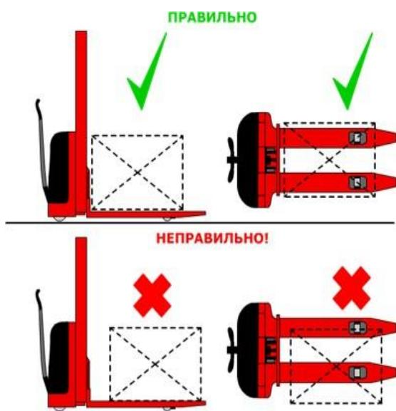
При использовании вилы должны быть помещены под груз так, чтобы груз опирался на каретку вил. Затем следует немного поднять вилы, чтобы груз устойчиво встал на вилы.
